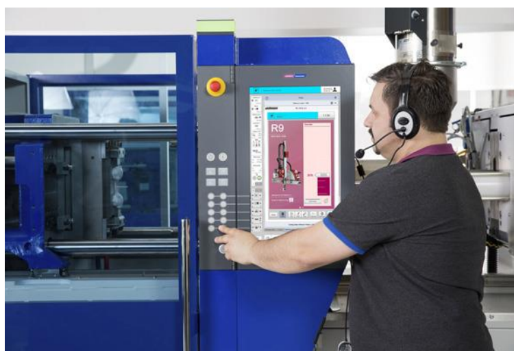
En operator som utför inställning av en robot via formsprutningsmaskinens UNILOG B8 kontroll.
